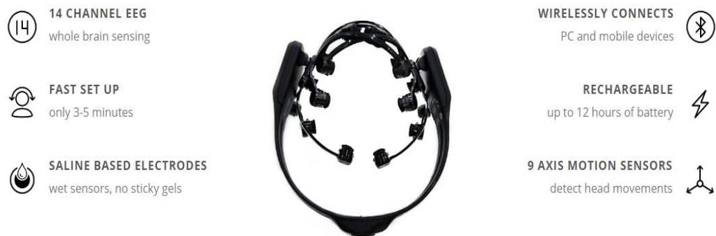
ภาพที่ 3-6 คุณลักษณะเบื้องต้นของเครื่องตรวจวัดและบันทึกคลื่นไฟฟ้าสมอง Emotiv รุ่น EPOC+
