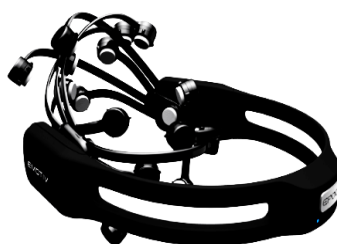
ภาพที่ 2-13 ลักษณะของเครื่องมือวัดคลื่นไฟฟ้าสมองแบบไร้สาย Emotiv EPOC+
